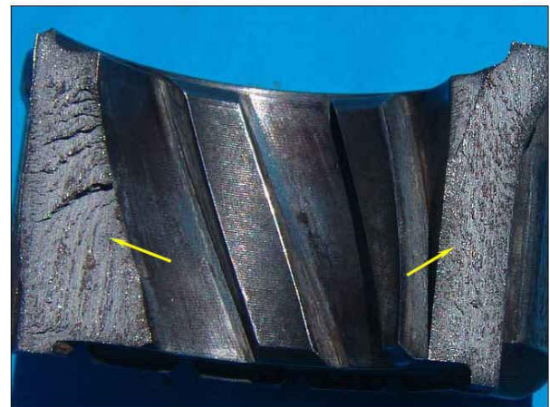
Foto 3. Superficies de fractura súbita frágil del piñón.
